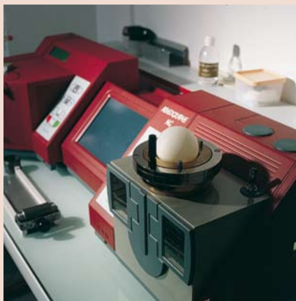
L'alvéographe de Chopin. L'élasticité de la pâte est mesurée pour déterminer la valeur boulangère d'une farine.
